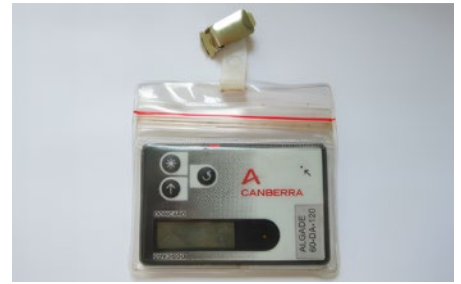
Figure 4 : Dosimètre opérationnel pour la surveillance de l'exposition externe : Type Dosicard
