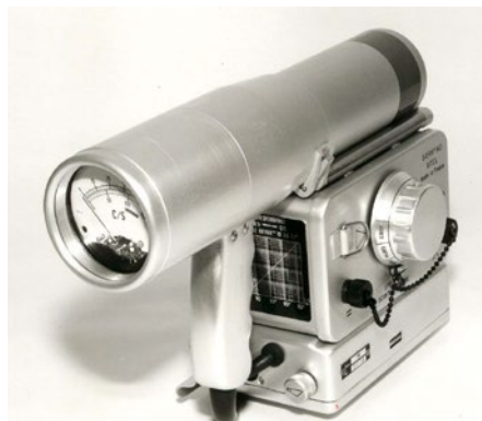
Figure 2 : scintillateur portatif de type SPP2 (mesure de débit photons Gamma) pour la localisation des zones présentant un marquage radiologique significatif exprimé en c/s
