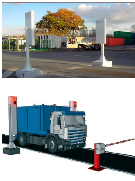
Figure 1 : Portique de détection de radioactivité.
