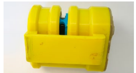
Figure 5 : Dosimètre individuel pour la surveillance de l'exposition externe GAMMA et interne ALPHA
