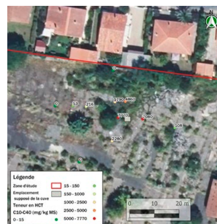
Figure 3 : Cartographie des résultats pour l'horizon 1-2 m
