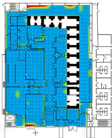
Figure 3 : Cartographie bidimensionnelle d'une contamination radioactive et la carte des incertitudes associée
