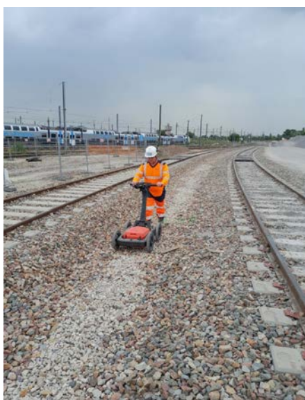
Fig 1 : Passage du géoradar en surface pour sécuriser le premier mètre
