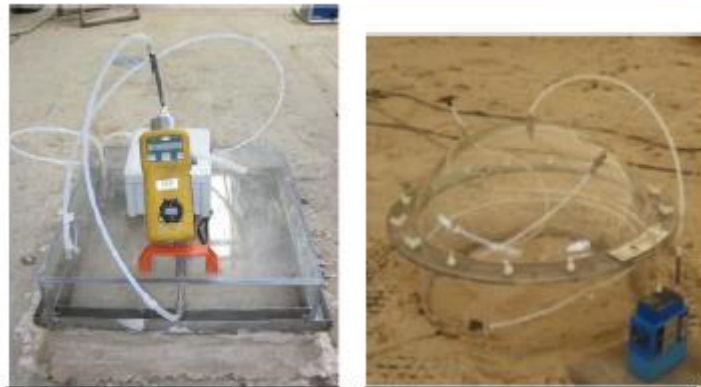
Figure 49 : Exemples de chambres à flux sur dalle béton ou sol nu (© Guide BRGM, INERIS, 2016).
