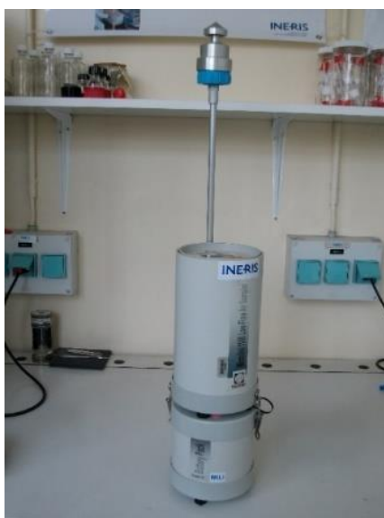
Figure 59 : Exemple de prélèvement de poussières en suspension dans l'air intérieur de logements (prélèvement en continu, à bas débit, durant une période de 7 jours consécutifs au niveau de la pièce de vie principale) (source : INERIS).
