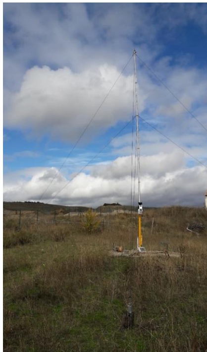
Figure 58 : Photographie d'une station météorologique avec mât de 10 m (source : EVADIES/BRGM).
