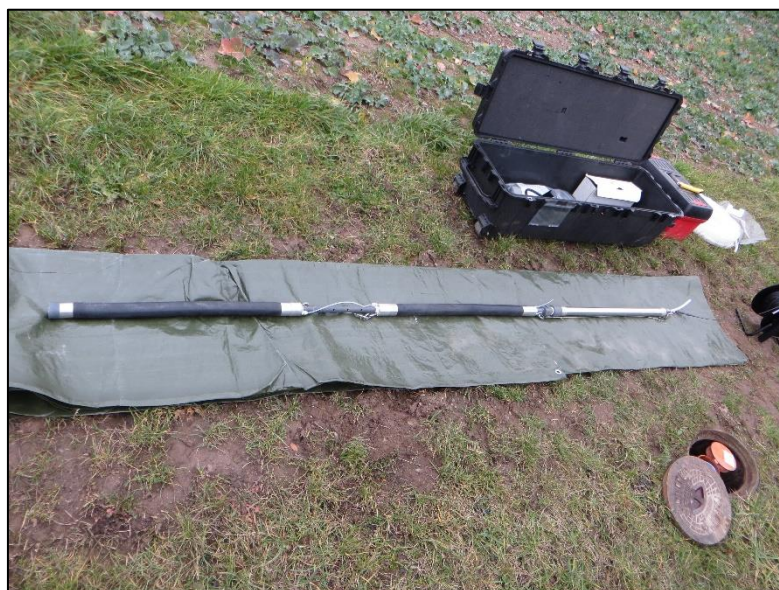
Figure 35 : Préleveur multi-niveaux à bas débit (source BRGM).
