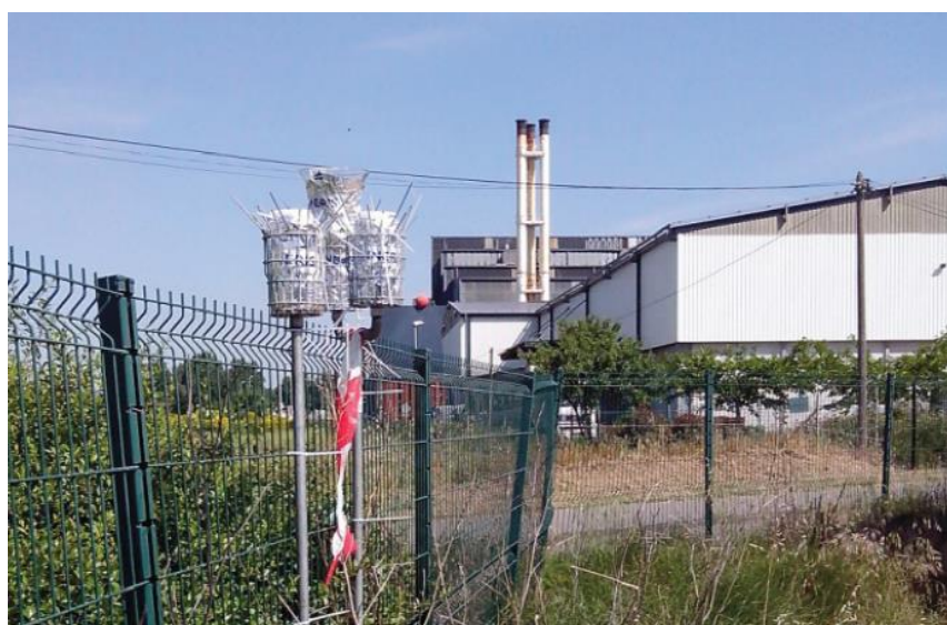
Figure 60 : Exemples de collecteurs de dépôts atmosphériques totaux (source : photo en haut EVADIES/Brgm, photo en bas INERIS).
