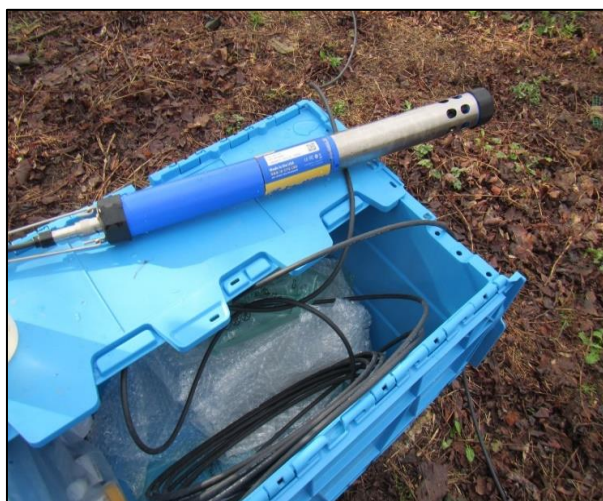
Figure 22 : Exemple de sonde permettant de réaliser des diagraphies des eaux souterraines (Aquatroll 600) (source INERIS).
