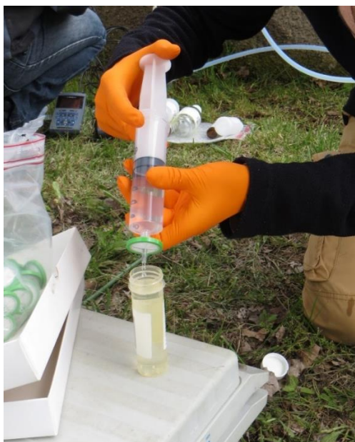
Figure 28 : Exemple de filtration à l'aide d'une seringue et d'un filtre (source BRGM).
