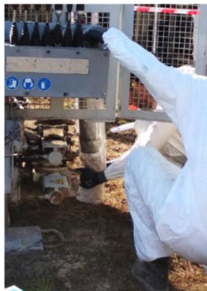
Figure 12 : Exemple de sondage réalisé au carottier Sonique (à gauche) - Ensachage de la carotte (à droite et en bas).
