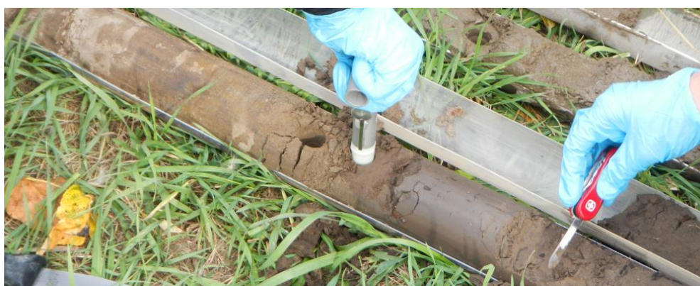
Figure 15 : Prélèvement de sol avec un cylindre d'échantillonnage en inox (photo du haut) et un échantillonneur à usage unique (photo du bas).
