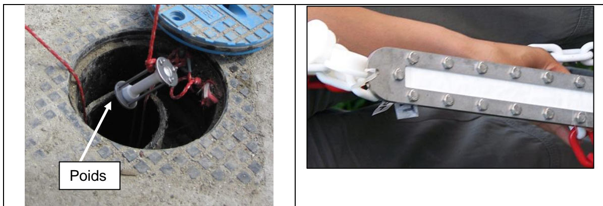
Figure 33 : Exemple d'échantillonneurs passifs intégratifs : Dosimètre en céramique (à gauche) POCIS pour les polluants polaires (à droite) (source INERIS).
