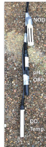
Monitoring du pilote de biostimulation : détail des piézomètres en flûte de pan (gauche) et des sondes in-situ (droite)
