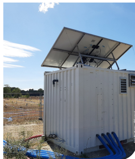
Process de dépollution in-situ à énergie solaire
