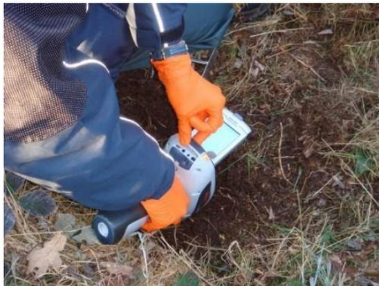
Figure 16 : Analyseur portable à fluorescence de rayon X (© BRGM).
