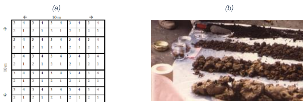
Figure 25 - Le support de l'information est très différent lorsque les terrains sont prélevés (a) à la tarière à main dans des placettes (OFEV, 2003) ou (b) dans des sondages réalisés à la foreuse (photo : Hélène Demougeot-Renard).
