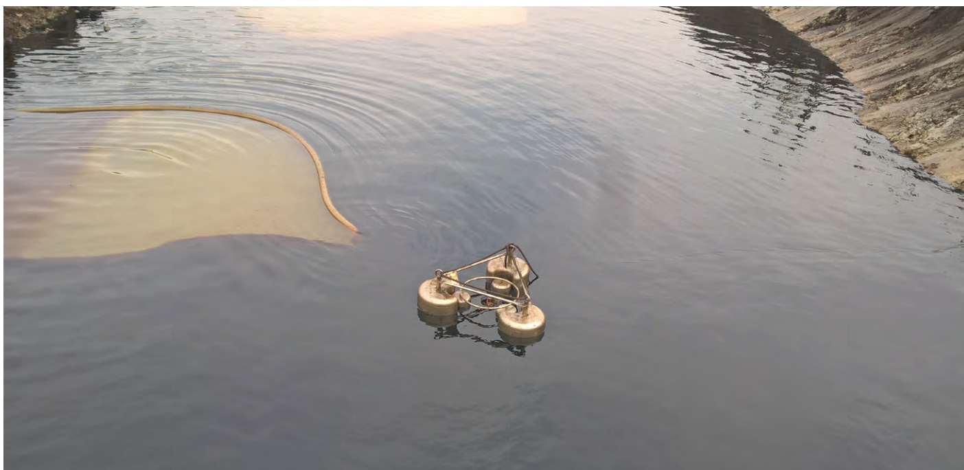
Skimmer permettant de récupérer les hydrocarbures dans les flottants
