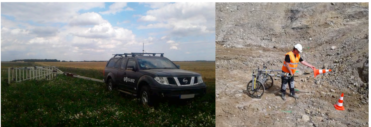
Figure 1 : Multidétecteur magnétométrique, tracté par un véhicule (à gauche), et tracté manuellement (à droite).
