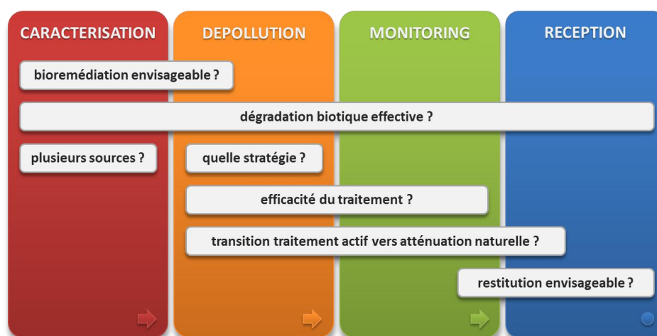
Figure 1 : Exemples de réponses apportées par les outils de biologie moléculaire au cours des différentes étapes de traitement de sites et sols pollués.
