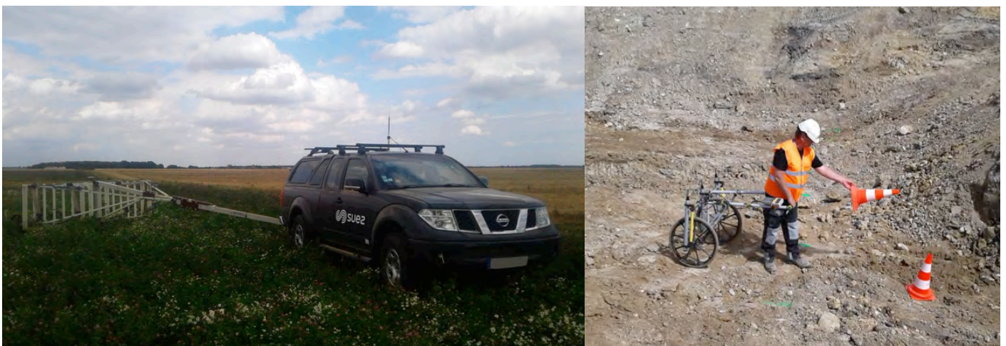
Figure 1 : Multidécteur magnétométrique, tracté par un véhicule (à gauche), et tracté manuellement (à droite).
